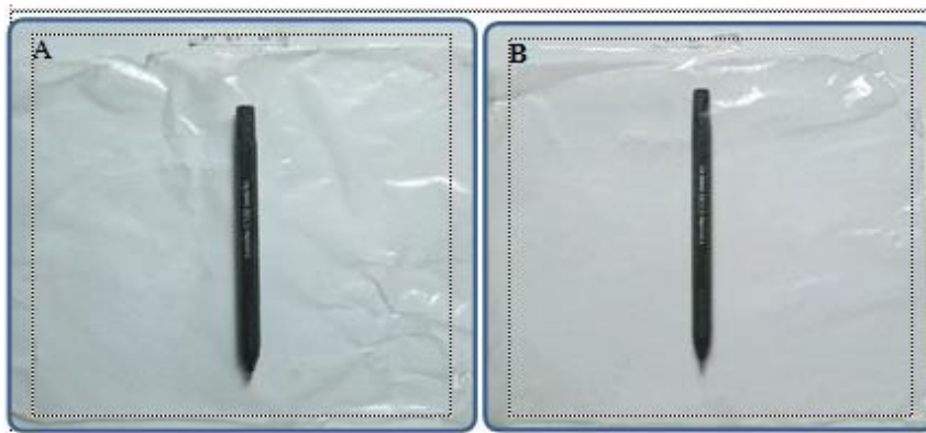
Gambar 6. Penampakan visual edible film suhu pemanasan 63 °C (A) dan suhu pemanasan 97 °C (B).
